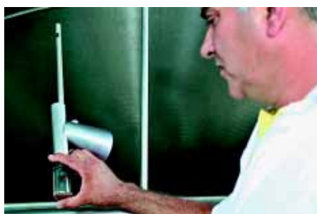
Ainda na propriedade rural, o teste alizarol identifica se há acidez no leite
