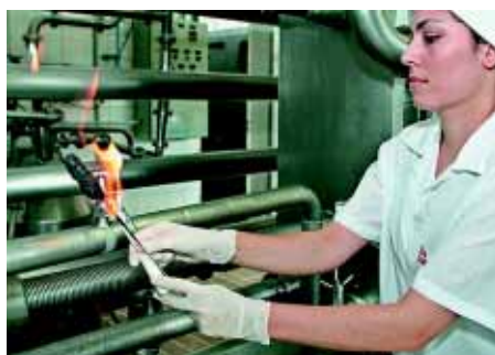
Amostra retirada do pasteurizador é aquecida para o teste de microbiologia
